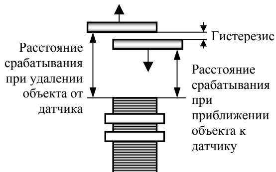
Для всех коммутирующих датчиков необходим гистерезис для устранения дребезга выходов. У индуктивных выключателей гистерезис получается от разности рабочих расстояний до объекта при приближении и удалении измерительной пластины и составляет ок. 10% от номинального расстояния срабатывания.
