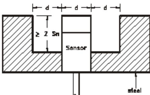
Датчики при монтаже не заподлицо обеспечивают наибольшее расстояние срабатывания. При этом в окружающем металле требуется наличие минимальной выемки. При этом: боковой промежуток = диаметру датчика, глубина = удвоенному номинальному расстоянию срабатывания.
